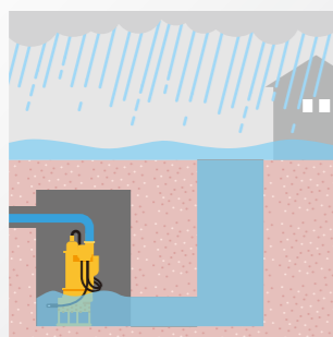
ゲリラ豪雨や大雨で増水と考えられる水路への事前設置
