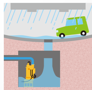
ゲリラ豪雨や大雨で冠水すると考えられる道路やアンダーパスへの事前設置
